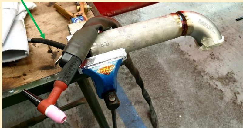
Entrée du gaz dans le tube pour le chambrage
