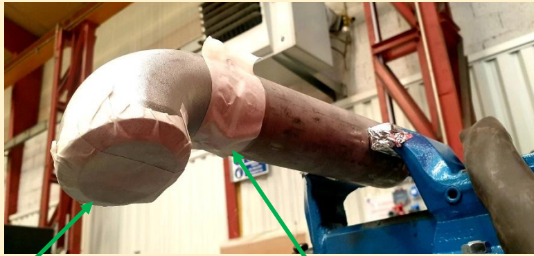
Le joint a soudé partiellement couvert par l'adhésif.
